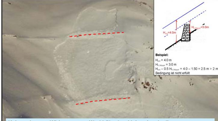
**Keine relevante Wirkung**, wenn Werkhöhe 2 m kleiner ist als die extreme Schneehöhe: Steinmauern mit ungenügender Werkhöhe ( $H_k < H_{ext} - 2\text{ m}$ )
