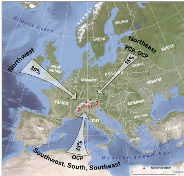
Figure 27 : Résultat des mesures sur les masses d'air : impact sur les pics alpins depuis trois directions dominantes ; comme indiqué, certaines directions affichent des concentrations de PCB et de POC plus élevées. 33
