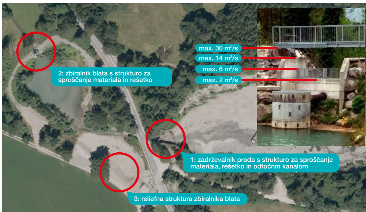
Slika 49: Podroben pregled različnih tehničnih struktur na hudourniku (©Urad za civilno zaščito, Lihtenštajn)
