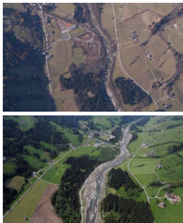
Figure 16 : Élargissement d'une rivière – Mareiterbach ; avant-après, Haut-Adige/Sud-Tyrol (©Province autonome de Bolzano/Bozen, Agence de la Protection civile)
