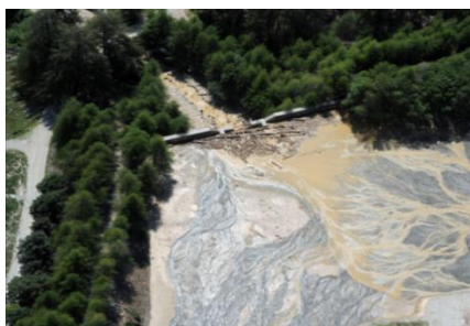
Abb. 21: Gadriabach: Einzelheiten der Blockierungsmechanismen (d.h. durch Treibholz und Feststoffe) in den Sperrenöffnungen und die daraus resultierende Aufschüttung des Rückhaltebeckens.
