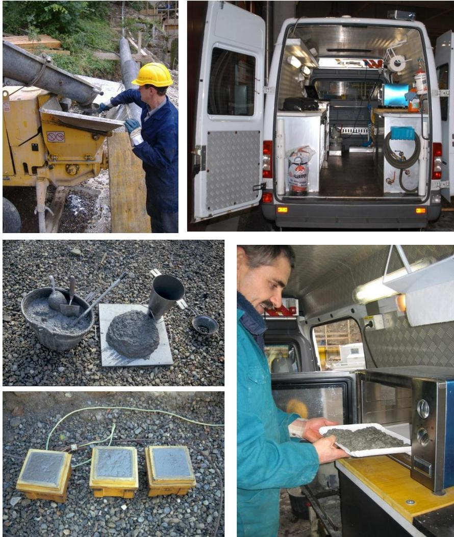
Mobile Einheit zur Qualitätskontrolle von Baumaterialien in der frühen Bauphase - ein Beitrag zur längeren Lebensdauer und einer erhöhten Zuverlässigkeit von Schutzbauten (Autonome Provinz Bozen)
